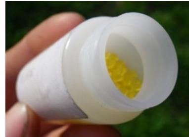
**Boîte avec grains de gel desséchant, utilisée pour la conservation des crottes avant analyse**
